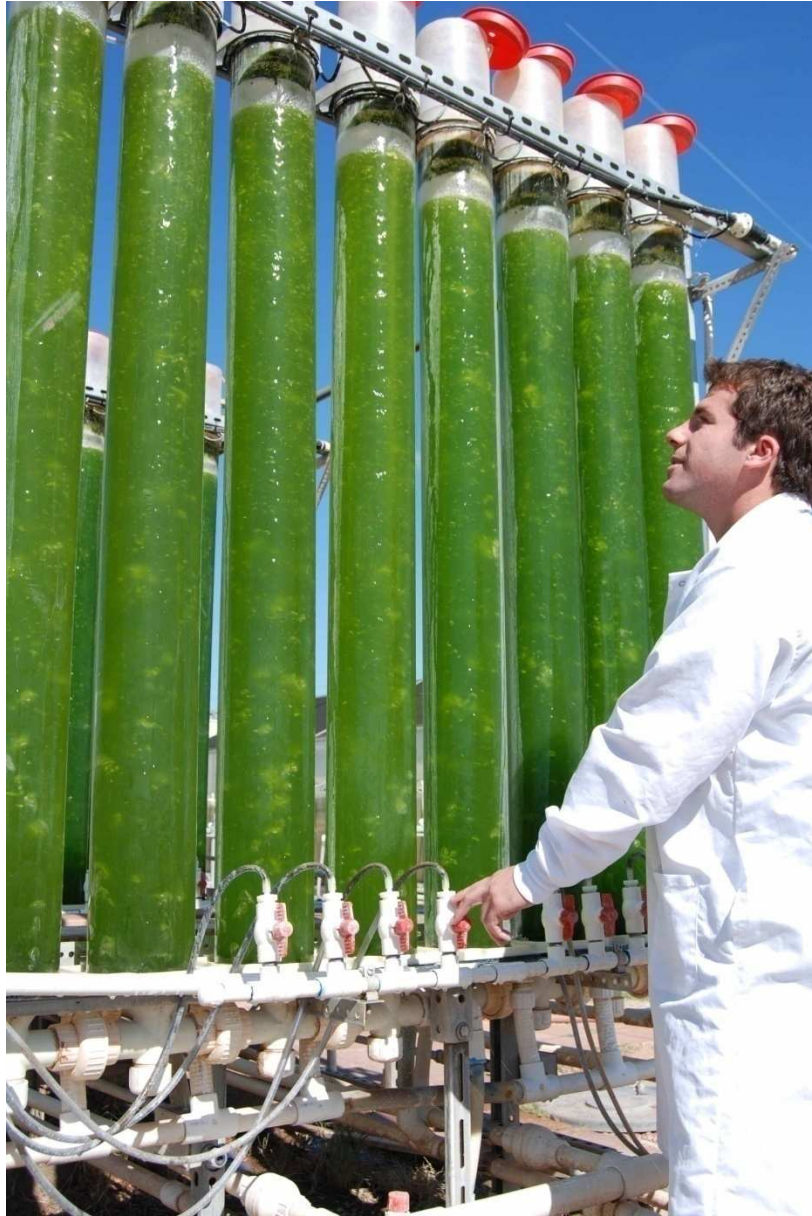
Figura 5: Foto de un fotobioreactor tubular vertical. [ www.algaegeek.com ].
