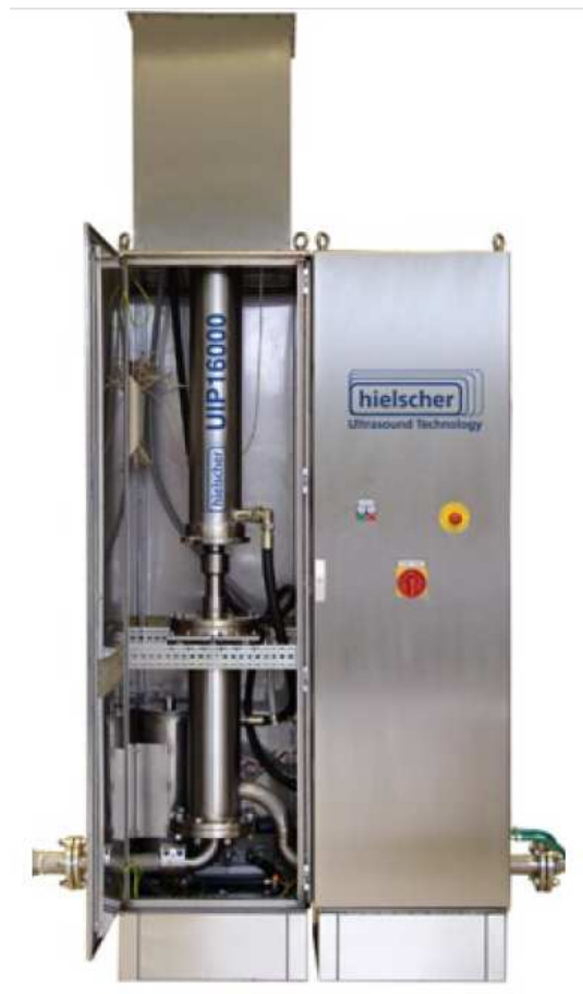
Figura 13: Foto de el equipo de ultrasonido UIP 16 000 de Hielscher.
