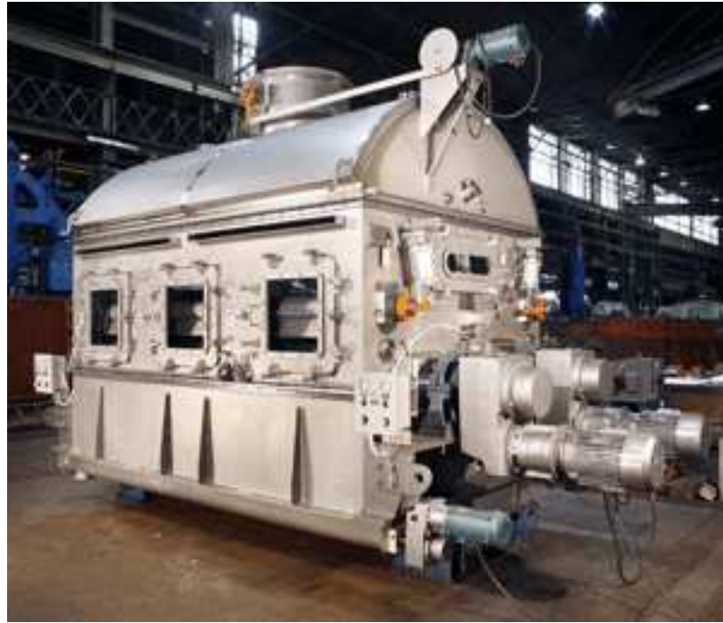
Figura 9: Tambor rotatorio doble de la empresa Buflovak.
