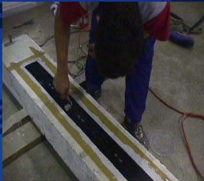
Refuerzo a Flexión de Vigas de Hormigón Armado con laminados de polímeros reforzados con fibras. TEC'4
