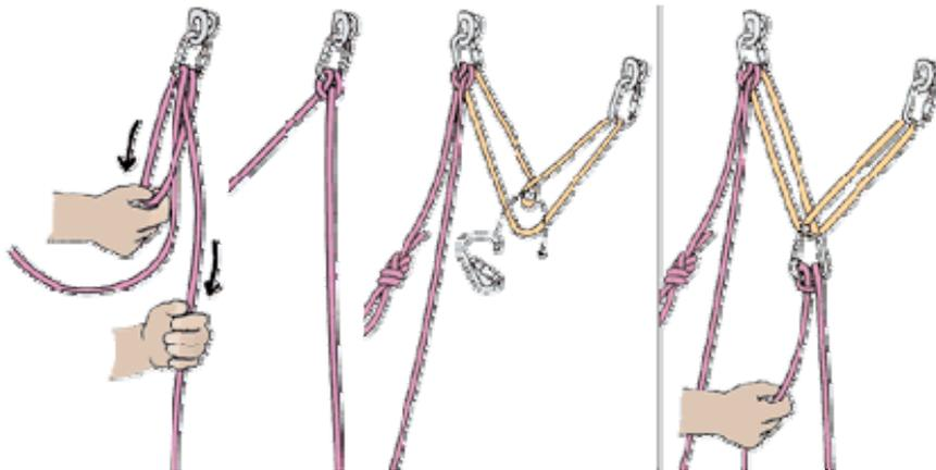
*Las primera ilustración muestra como acortar la soga de seguro sin soltarla, mientras que la segunda muestra la manera correcta de armar el triángulo de fuerza.*
