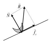
d) **Soporte de rodillo**: Para este tipo de conexión, la fuerza de contacto es perpendicular a la superficie soportante.
