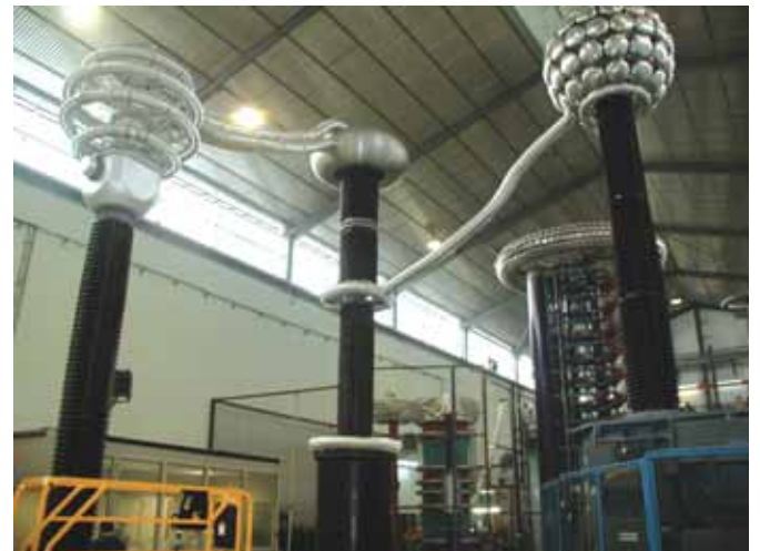
Test de rutina a Transformador de Intensidad de 765 kV
