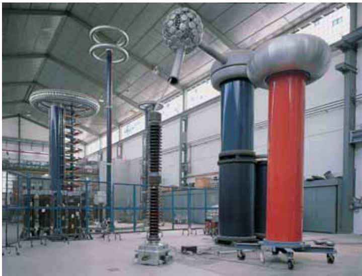
Test de rutina a Transformador de Intensidad de 765 kV
