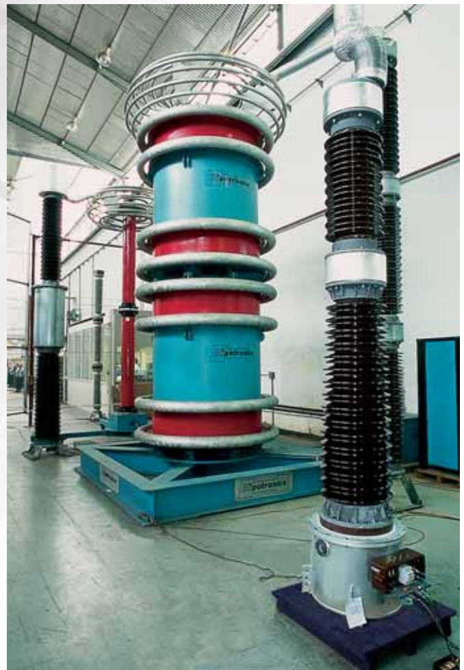
Ensayos de rutina a Transformador de Tensión Capacitivo de 245 kV.
