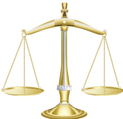
Figura 7. Balanza de platillos, mide la masa comparándola con la de otros cuerpos de masa conocida.
