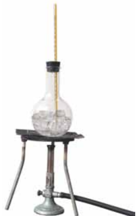
Figura 5. Montaje de laboratorio para la medida de la temperatura del agua expuesta al calor.
