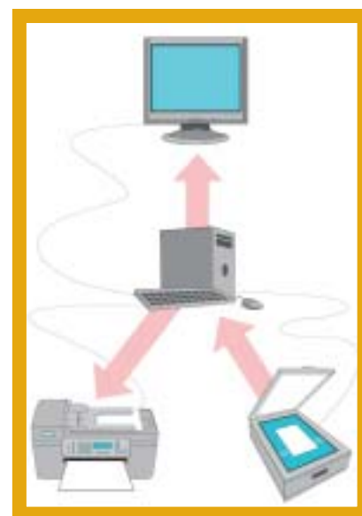
En este diagrama podemos observar un ejemplo básico de la interacción de tres periféricos con el cuerpo de la PC; las flechas indican entradas y salidas.
