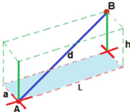
Al trazar la diagonal (s) de la base del prisma, se forman dos triángulos rectángulos, uno en la base y otro perpendicular a este, entre la diagonal de la base (s), la diagonal del prisma (d) y la altura (h), tal como se ilustra a continuación.
