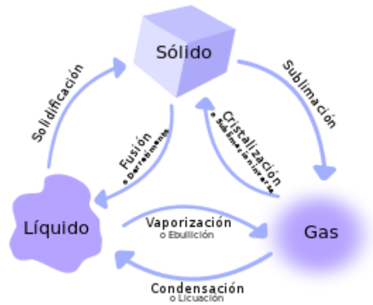
Diagrama de los cambios de estado entre los estados sólido, líquido y gaseoso.
