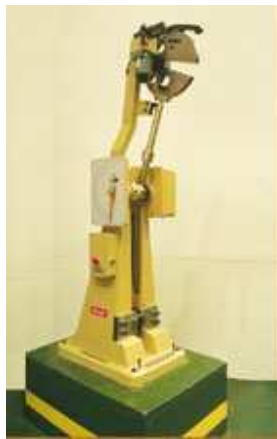
Figura 2.7. Máquinas Charpy con diferentes capacidades
