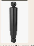
**Hidráulicos:** Utilizan aceite para disipar energía.
