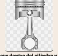
**Pistón:** Se mueve dentro del cilindro y absorbe energía.
